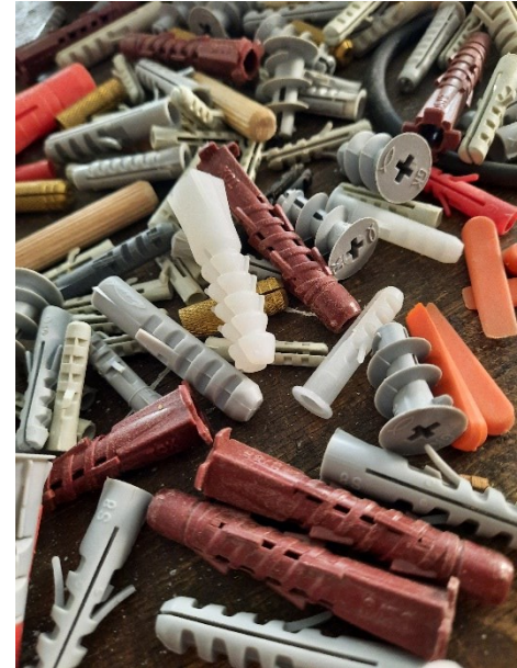
Abbildung 9: Kleinteile wie Dübel sind oft aus Kunststoffen (Bild: IBO GmbH)
